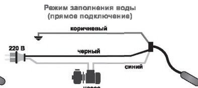
Режим заполнения воды (прямое подключение)
